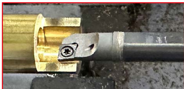
Vyvrtávací tyč pro obrábění malých dílů Minimální průměr obrábění 9 mm
