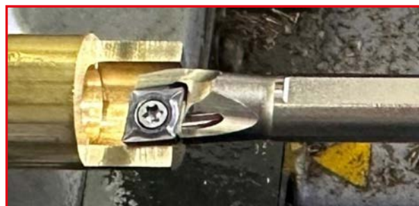
Vyvrtávací tyč Minimální průměr obrábění 10 mm
